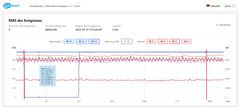
Abb. 4. Verlustfaktor im Transformator K – RMS_{U2} des Ereignisses
